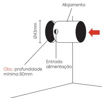
2A. Faça a ligação elétrica entre os cabos da luminária aos cabos do transformador 12V, isolando-os corretamente.
