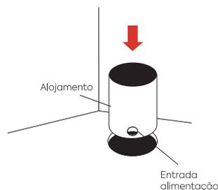
2B. Preparar o local onde será instalado o corpo do alojamento (3) deixando o espaço para colocação do elemento de drenagem (1) (pedra britada ou argila expandida), a drenagem total da água deve ocorrer em até 20 minutos. Passar a fiação (2) de alimentação da rede pelo orifício do corpo do alojamento (3). Instalar o alojamento (3).
