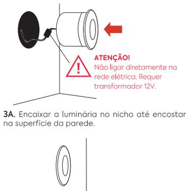
3A. Encaixar a luminária no nicho até encostar na superfície da parede.
